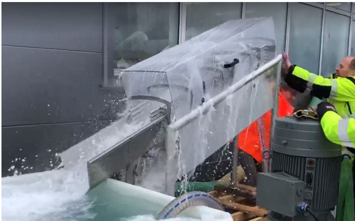
Figur 3. I forkant av utprøving i kommersiell skala ble det gjennomført en pilot hvor fisk av ulike størrelser ble sendt gjennom enheten med og uten Optiflush aktivert.
